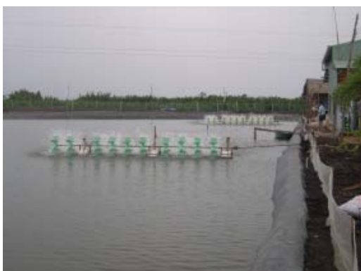
Hình 2.16: Máy quạt nước có cánh tay đòn dài dùng mô-tơ điện kéo và máy đập nước (Nguồn: Phương 2003)
