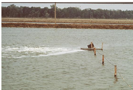
Hình 2.16: Máy quạt nước có cánh tay đòn dài dùng mô-tơ điện kéo và máy đập nước (Nguồn: Phương 2003)
